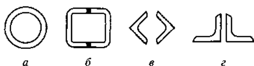
Рис. 21.9. Типы сечений раскосов связевых ферм:
